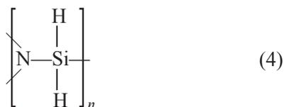
Таким образом, при малом расходе аммиака образуются молекулы полисилазана с высокой степенью разветвления. При большом расходе аммиака в зоне ввода формируется локальная область его повышенной концентрации, что приводит к протеканию реакции в этой области по уравнению (5) с образованием силандиамина:
