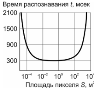
Рис. 15. Зависимость времени зрительного распознавания образа от логарифма площади информационного пикселя, измеряемого в метрах
