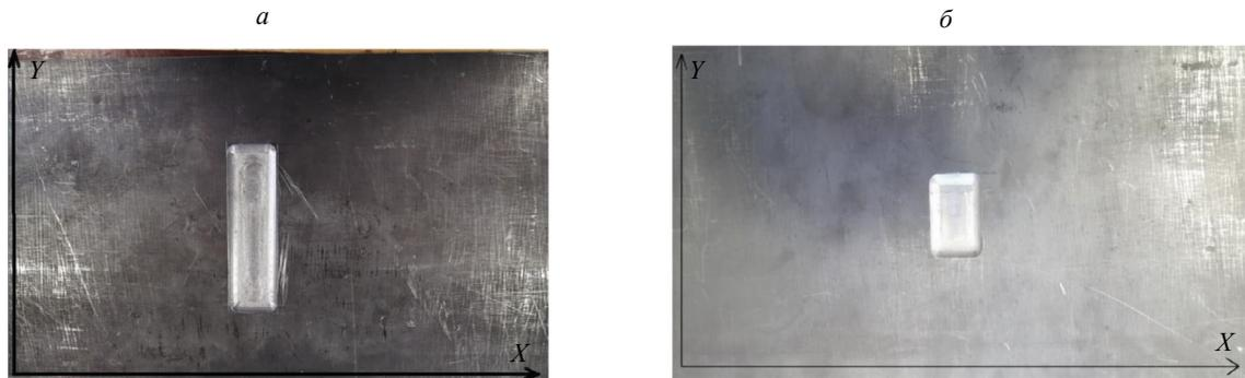
Рис. 3. Искусственно созданные дефекты: размеры  $30 \times 100 \times 4$  мм (а); размеры  $30 \times 40 \times 5$  мм (б). На рисунке указаны оси  $X$  и  $Y$ .
