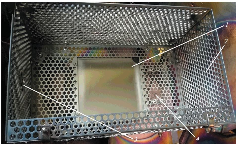
**Рис. 1.** Фотография разрядной ячейки системы очистки первого зеркала диагностики “Активная спектроскопия”. 1 – макет входного зеркала; 2 – сетчатые стенки разрядной ячейки; 3 – анод; 4 – термоэмиссионный катод.
