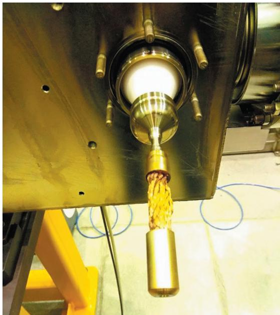
Рис. 7. Генераторная часть токоввода с гибким контактом.
