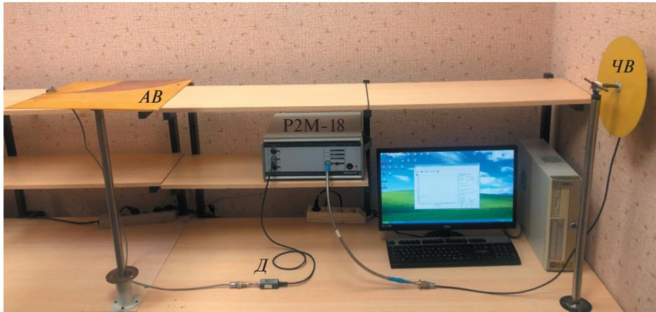
**Рис. 6.** Схема установки для измерения диаграммы направленности и коэффициента усиления антенны Вивальди. ЧВ – четвертьволновый вибратор; АВ – антенна Вивальди; Д – детекторная секция; P2M-18 – скалярный с.в.ч.-анализатор.
