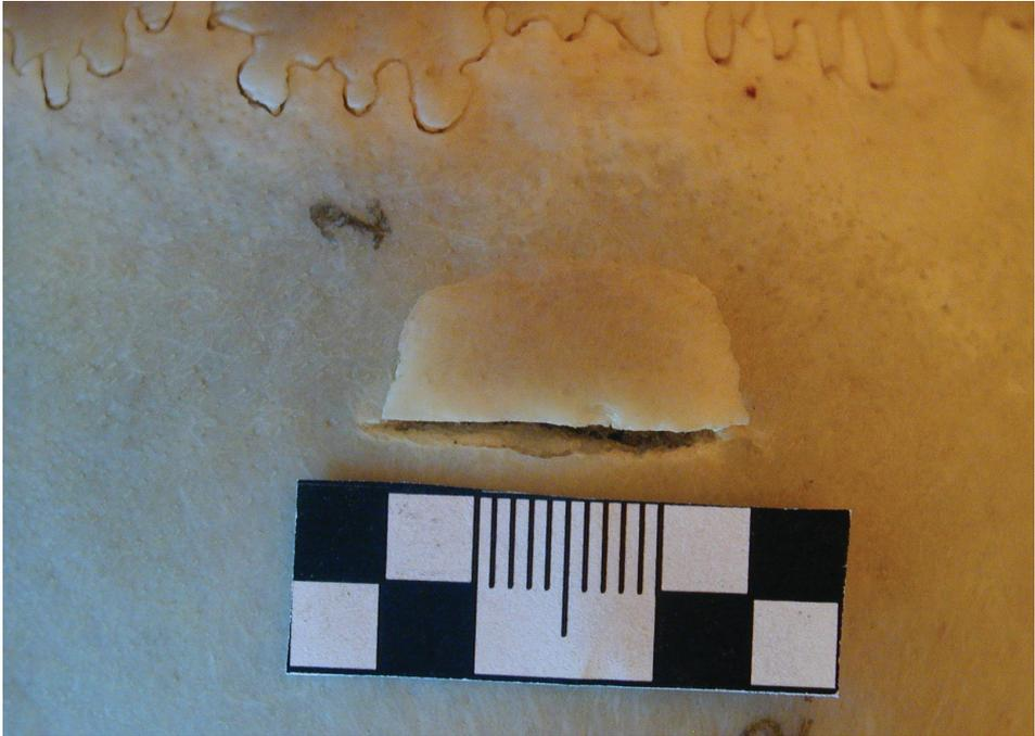
Формирование трещин при малой силе удара рубящим предметом
