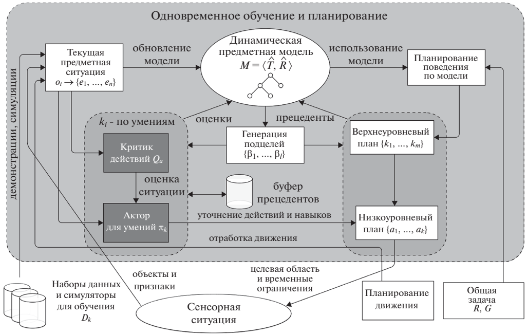
Рис. 2. Архитектура SLAP агента с подсистемами обучения (выделены темным цветом) и планирования поведения. Данная схема представляет собой верхний уровень архитектуры STRL, которая изображена на рис. 1, с детализацией взаимодействия методов обучения и планирования.
