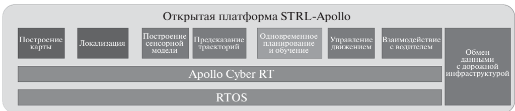
Рис. 4. Схема использования SLAP агента в качестве модуля в системе управления Apollo.
