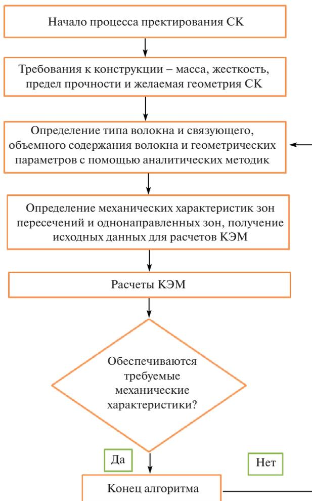
Рис. 1. Алгоритм определения конструктивных параметров СК.
