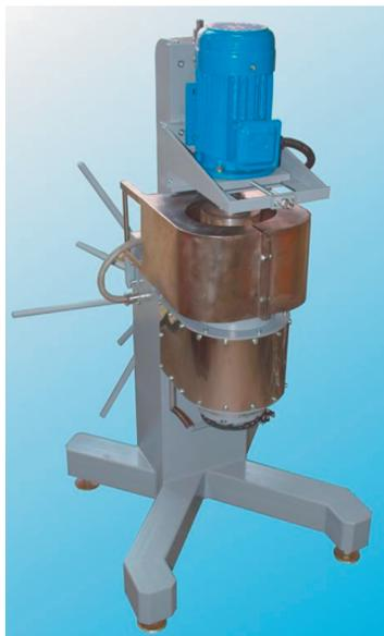
**Рис. 1.** Экспериментальная установка волнового смешивания VM-58.
