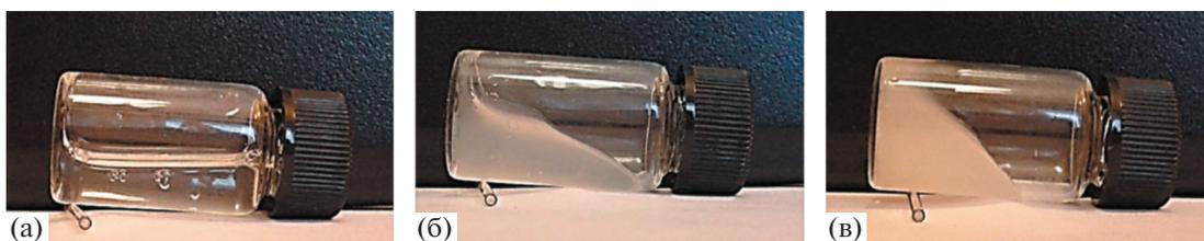
**Рис. 1.** Фотографии вязкоупругих образцов, содержащих 0.044 моль/л (1.93 об. %) ОАБ и 0.004 моль/л (0.1 об. %) ДСН в отсутствие глины (а) и в присутствии 0.03 (б) и 0.1 об. % (в) глины бентонит. Цветные рисунки можно посмотреть в электронной версии.
