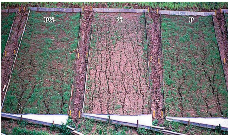
**Рис. 1.** Защита почвы путем нанесения водной суспензии ПАМ–гипс (слева), воды (в центре, контроль) и водного раствора ПАМ (справа). Использовано с разрешения издательства “American Society of Agricultural and Biological Engineers”, copyright D.C. Flanagan et al. (2002) [45].
