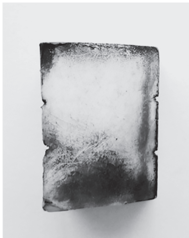
Рис. 2. Шашка фторопласта-4 с углеродным налетом, занимающим большую часть ее поверхности.
