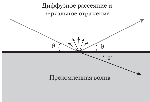
Рис. 1. Отражение и преломление рентгеновского излучения на поверхности материала.
