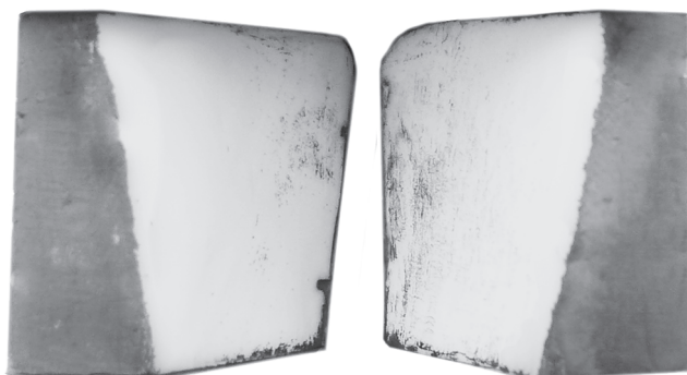
Рис. 6. Внешний вид шашек после работы и предварительного нагрева до 80°C при расстоянии между ними 20 мм.
