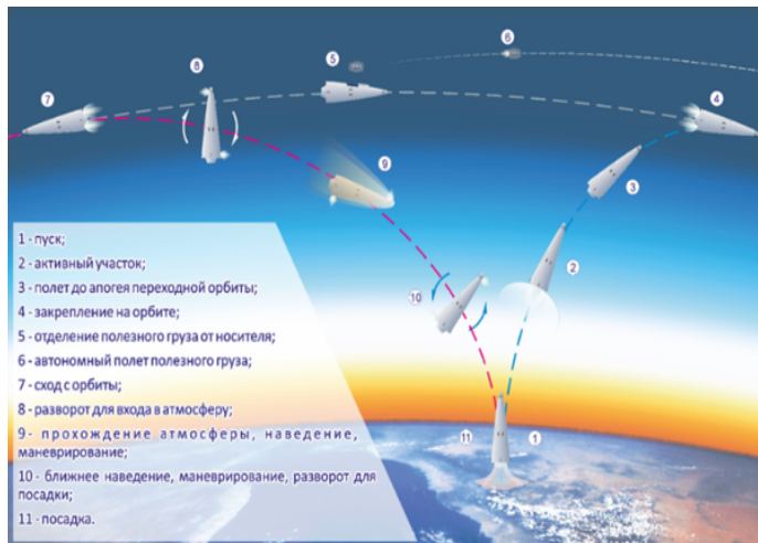
Рис. 3. Разработки многоразовых ракетно-космических систем АО "ГРЦ Макеева": внешний вид (а) и схема полета первой ступени ракеты-носителя «Россиянка(б); внешний вид (в) и схема полета ракеты-носителя КОРОНА (г)
