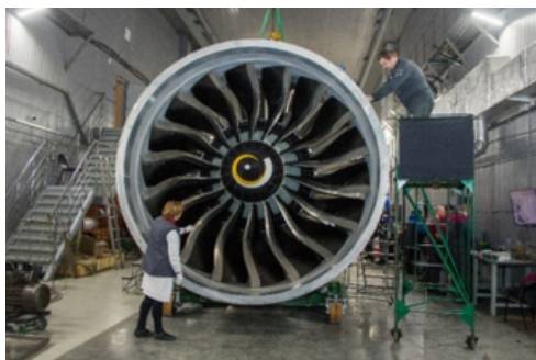
Рис. 2. Сборка и подготовка к испытаниям двигателя-демонстратора технологий ПД-35 а – рабочая лопатка вентилятора из полимерных композиционных материалов; б – двигатель-демонстратор полностью собран; в – двигатель-демонстратор подготовлен к испытаниям
