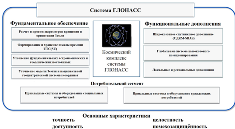
Рис. 2. Построение системы ГЛОНАСС
