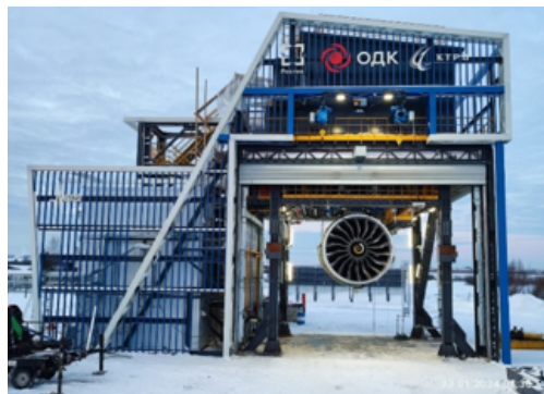
Рис. 2. Сборка и подготовка к испытаниям двигателя-демонстратора технологий ПД-35 а – рабочая лопатка вентилятора из полимерных композиционных материалов; б – двигатель-демонстратор полностью собран; в – двигатель-демонстратор подготовлен к испытаниям
