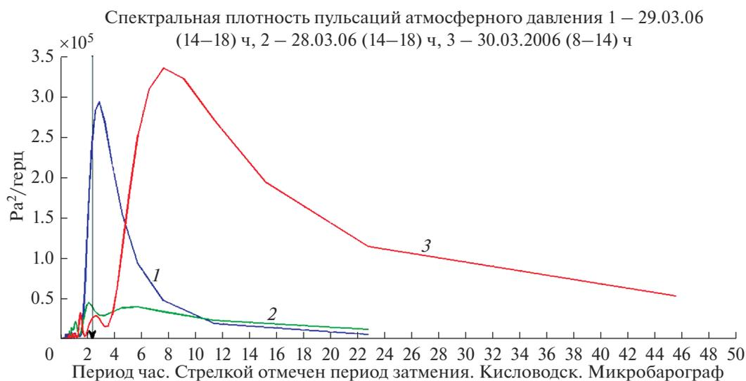
**Рис. 7.** 1 — спектральная плотность пульсаций атмосферного давления записанных во время солнечного затмения 29.03.2006. на интервале времени 14–18 ч, 2 — аналогичные значения, полученные 28.03.2006 на интервале времени 14–18 ч ; 3 — 30.03.2006. на интервале времени 8–14 ч. На горизонтальной оси стрелкой отмечен период, соответствующий длительности солнечного затмения 2.33 ч.
