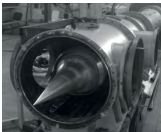
Рис. 29. Макет-демонстратор прямоточного воздушно-реактивного двигателя.
