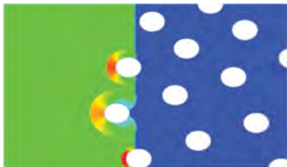
Рис. 5. Пример взаимодействия ударной волны с системой цилиндров.
