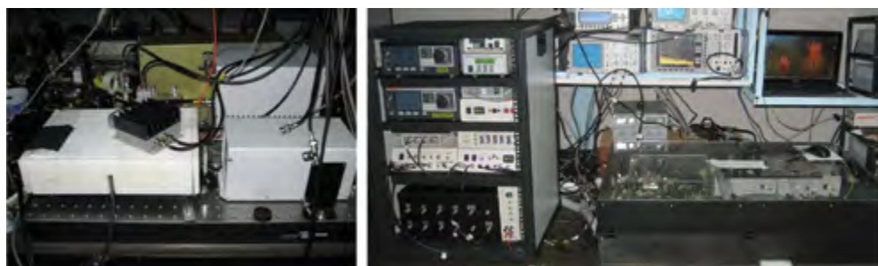
Рис. 15. Внешний вид Nd(Yb):YAG/12 оптического стандарта частоты (слева) и фемтосекундного волоконно-оптического синтезатора частот (справа).
