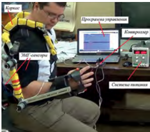
Рис. 25. Натурные испытания макета экзоскелета руки.
