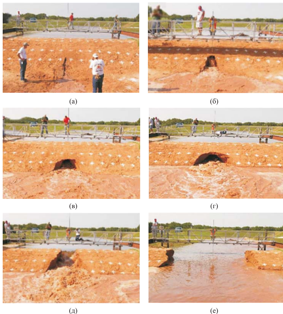
Рис. 4.1.6. Процесс размыва плотины при образовании свища, эксперимент Hanson et al., 2005 [Wu, 2016]: (а) – начальное отверстие (время 0 мин.); (б), (в), (г) – расширение свища в теле плотины (5, 8, 13 мин., соответственно); (д) – обрушение части плотины над свищем (13 мин.); (е) – выравнивание уровней верхнего и нижнего бьефов, окончание размыва, итоговая форма прорана (60 мин.)
