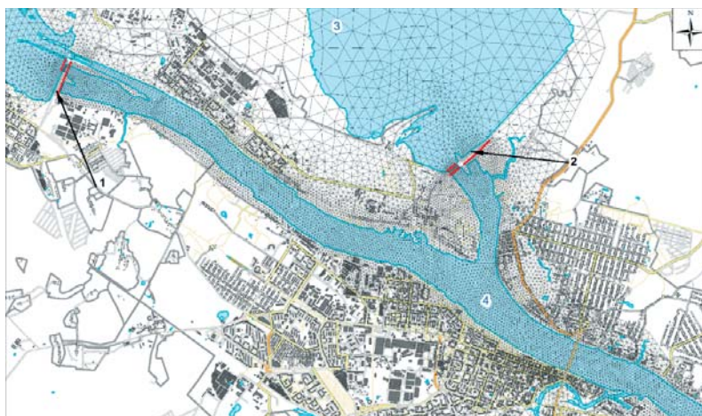
Рис. 8.1.4. Фрагмент расчетной сетки русла и поймы р. Волга в районе г. Рыбинска. 1 – Волжский створ; 2 – Шекснинский створ; 3 – Рыбинское водохранилище; 4 – Горьковское водохранилище (р. Волга)
