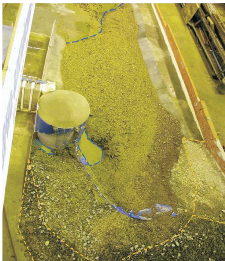
Рис. 5.2.12. Фотографии размыва физической модели каменно-набросной плотины: (а) – вид с нижнего бьефа; (б) – вид с верхнего бьефа
