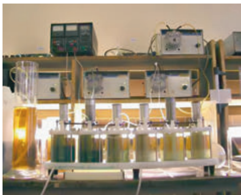
Рис. 69. Внешний вид установки для укрупненных лабораторных испытаний – лабораторный каскад экстракторов смешительно-отстойного типа конструкции и производства ИХТРЭМС [289]
