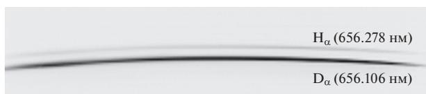
Рис. 8. Калибровочный спектр эталонной дейтериевой лампы ДДС-30, полученный спектрометром с пространственным разрешением.
