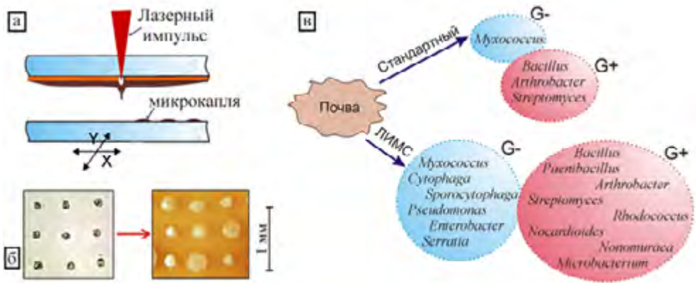
Рис. 18. Схема печати микрокаплями с живыми микробиологическими организмами (а); Микрокапли и образованные колонии микроорганизмов (б); Пример совокупности микроорганизмов различных видов, выделенных из образца почвы стандартным и разработанным (ЛИМС) способами (в)
