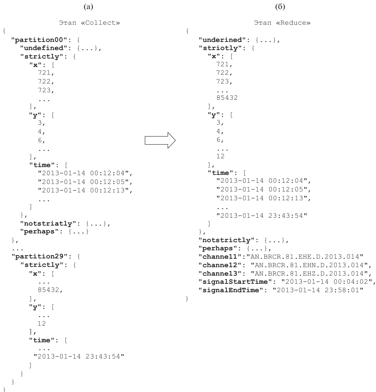
Рис. 4. Карта классификаций суточного сейсмического сигнала в виде JSON-файла на этапах а) Collect и б) Reduce , соответственно.
