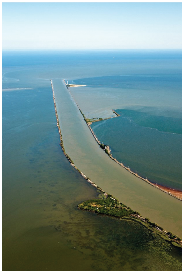
Рис. 4. Общий вид парных защитных молв Сулинского порта, которые перекрыли движение влекомых и части взвешенных наносов из Дуная на юг. Вид с северо-запада на юго-восток.
