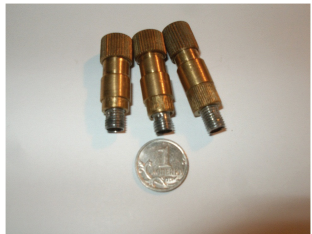
Рис. 3. Коаксиальные электроакустические преобразователи диапазона 12...18 ГГц.
