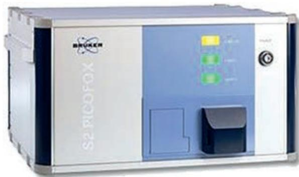
Рентгенофлуоресцентный спектрометр с полным внешним отражением (фирма «Брукер»)
