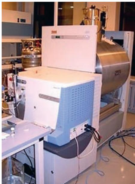
Масс-спектрометр ионного циклотронного резонанса с преобразованием Фурье
