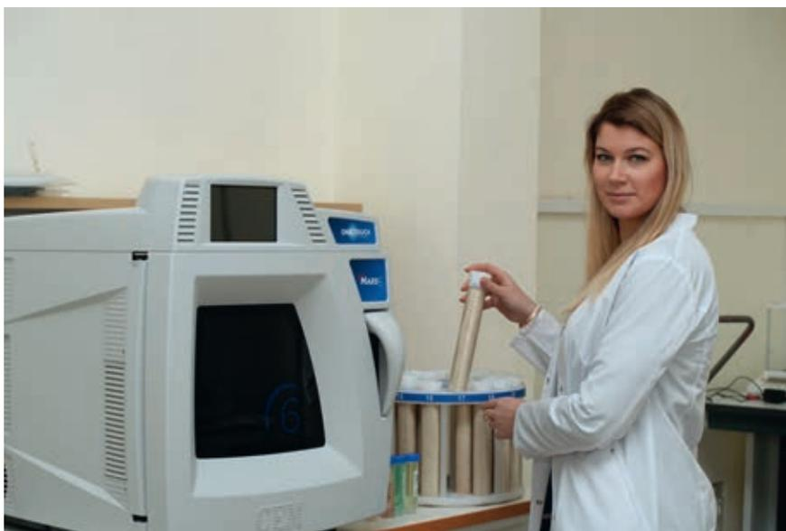
В ЦКП ИОНХа. Пробоподготовка с использованием микроволновой печи
