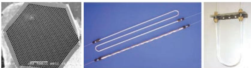
Поликапиллярные хроматографические колонки: поперечный срез; S-образные; прямые в защитных трубках; U-образные
