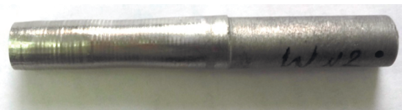
Рис. 4. Затравочный кристалл вольфрама.
