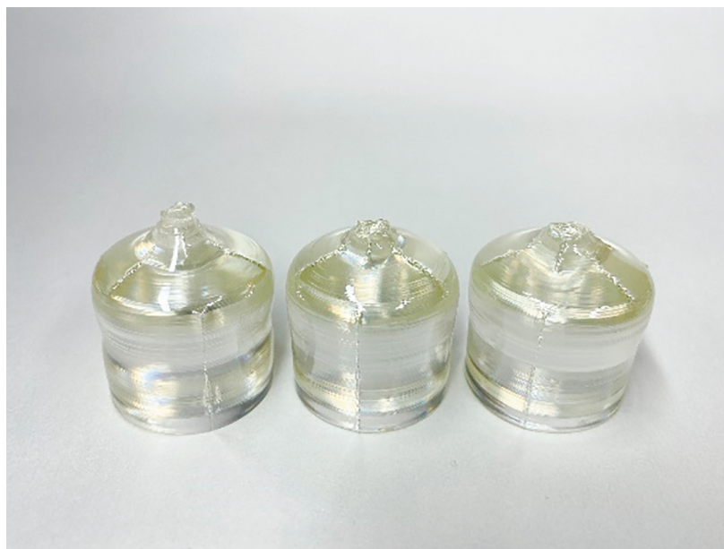
Рис. 2. Монокристаллы \text{LiNbO}_3:\text{Mg,B} , выращенные из расплава путем последовательного разбавления плава номинально чистой шихтой конгруэнтного состава.
