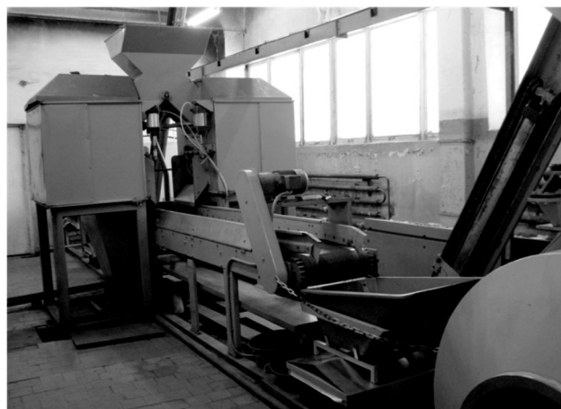
Рис. 1. Получение свекловичных дигератов на автоматизированной линии Veneta.
