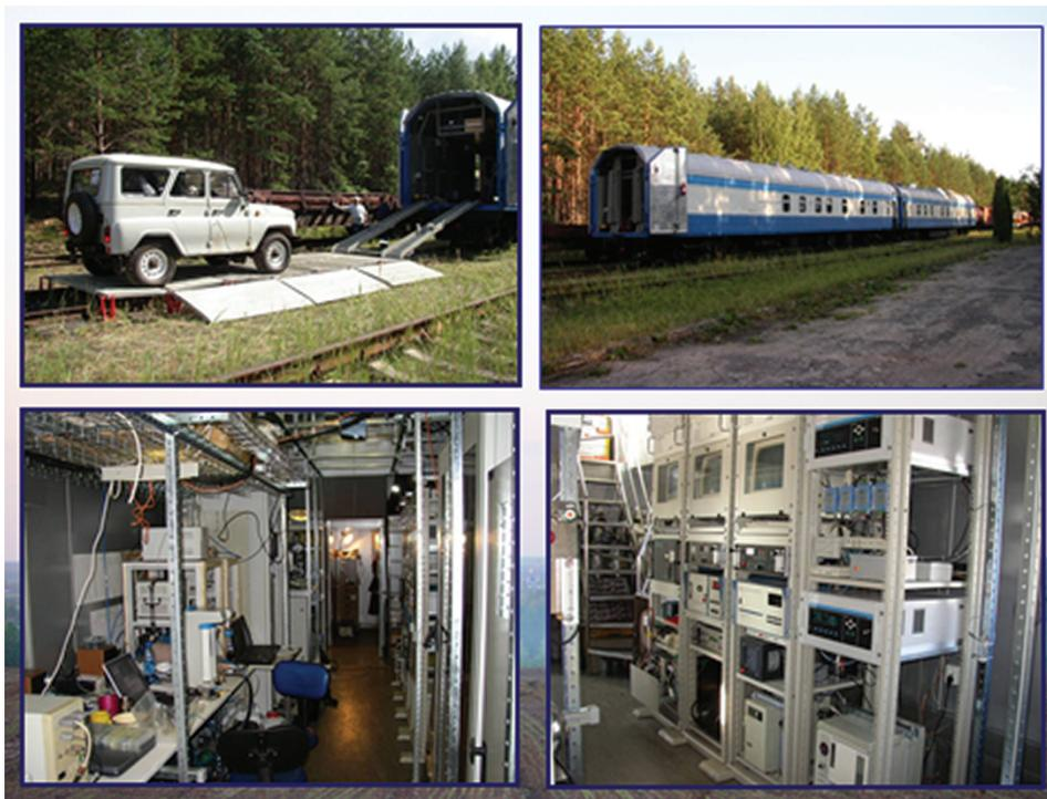
**Рис. 1.** Передвижная лаборатория TROICA в полном составе (из 2 вагонов) (вверху). Внутренний вид вагона-обсерватории с автоматизированным комплексом для измерения состава атмосферы (внизу).
