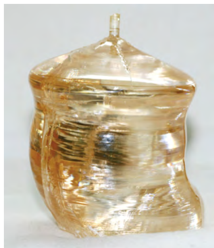
Рис. П2 Крупногабаритный (диаметр \sim 80 мм) кристалл \text{LiNbO}_3\text{:Zn} ( [\text{ZnO}] \approx 5 мол% в кристалле), прямое легирование. Наследование винтовой дислокации от заправки
