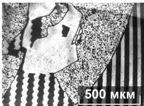
Рис. П86 Доменная структура кристалла \text{LiNbO}_3\text{:Gd} ( [\text{Gd}] = 0.38 мас% в кристалле, прямое легирование, после ТО, Z-сре́з).
