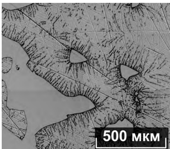
Рис. П130 Макродоменная структура с прорастанием цепочек микродоменов противоположного знака в кристалле \text{LiNbO}_3:\text{Mg} ( [\text{MgO}] = 4.9 мол% в кристалле, прямое легирование, в процессе ВТЭДО, Z-срез).
