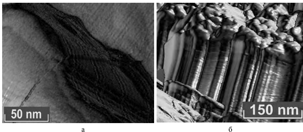
Рис. 1.18. Периодические наноразмерные структуры фрактального типа на отрицательной доменной стенке РДС в кристалле \text{LiNbO}_3:\text{Tb} № 5 ( [\text{Tb}] = 2.54 \text{ мас\%} ): (а) – перпендикулярно оси z , (б) – параллельно оси z
