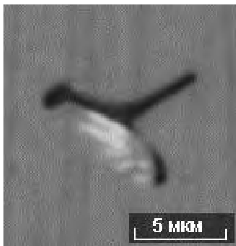
Рис. П108 Остаточный («упрямый») микродомен в кристалле \text{LiNbO}_3:\text{Mg,Fe} ( [\text{MgO}] \approx 5.23 мол% в кристалле; [\text{Fe}_2\text{O}_3] = 0.005 мол% в кристалле, гомогенное легирование, после ВТЭДО, X-срез).
