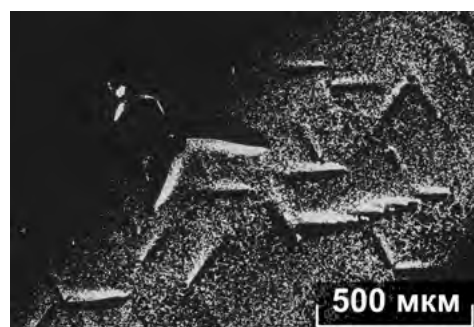
Рис. П32 Выделение второй фазы в кристалле \text{LiNbO}_3:\text{Er} ( [\text{Er}] = 3,6 \text{ мас\%} в расплаве). После ТО. Z-срез
