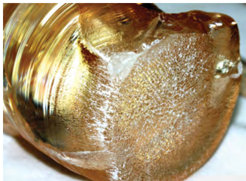
Рис. П4 Ячеистый рост в нижней части крупногабаритной булы кристалла \text{LiNbO}_3:\text{Zn} ( [\text{ZnO}] \approx 5 мол% в расплаве), прямое легирование
