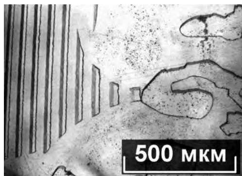
Рис. П92 Фрагмент ростовой доменной структуры кристалла \text{LiNbO}_3:\text{Gd} ( [\text{Gd}] = 0.38 \text{ мас\%} в кристалле, прямое легирование, после ТО, X-срез).
