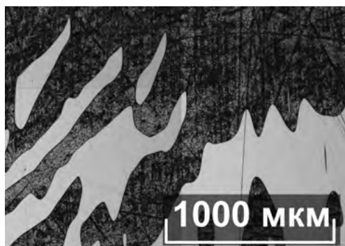
Рис. П82 Нерегулярная («диффузная») доменная структура в кристалле \text{LiNbO}_3:\text{Mg} ( [\text{MgO}] \approx 4.6 мол% в расплаве, совместный твердофазный синтез, X-срез).
