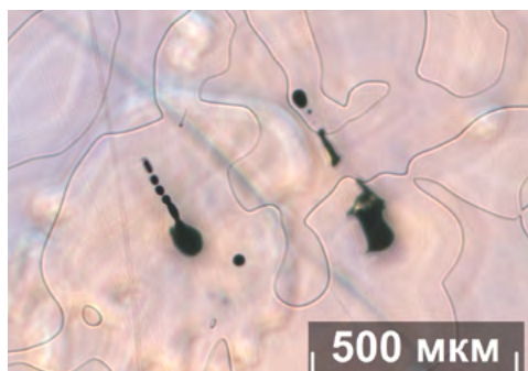
Рис. П11 Макродефекты в виде «каналов» в кристалле \text{LiNbO}_3\text{:B} ( [\text{B}] = 0.2 \text{ мас\%} в расплаве). Наблюдение в режиме ДИК. Z-срез
