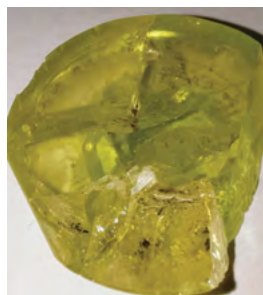
Рис. П4 Макроструктура кристалла \text{LiNbO}_3:\text{Pr} № 3, исследованная в режиме ДИК: блочная структура, разделенная пакетами двойников (а); общий вид були кристалла \text{LiNbO}_3:\text{Pr} № 3 (б, в).
