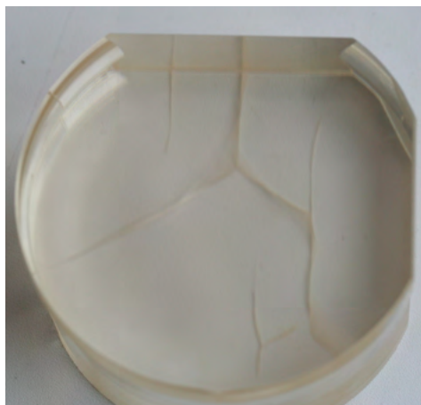
Рис. П21 Трещины в кристалле \text{LiNbO}_3\text{:Mg} ( [\text{MgO}] \approx 4 мол% в кристалле). Прямое легирование. Z-срез. Трещина развивалась в соответствии с симметрией кристалла \text{LiNbO}_3 под углами между отдельными ветвями \sim 120 градусов
