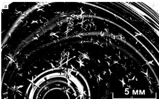
Рис. П92 Фрагмент ростовой доменной структуры кристалла \text{LiNbO}_3:\text{Gd} ( [\text{Gd}] = 0.38 \text{ мас\%} в кристалле, прямое легирование, после ТО, X-срез).
