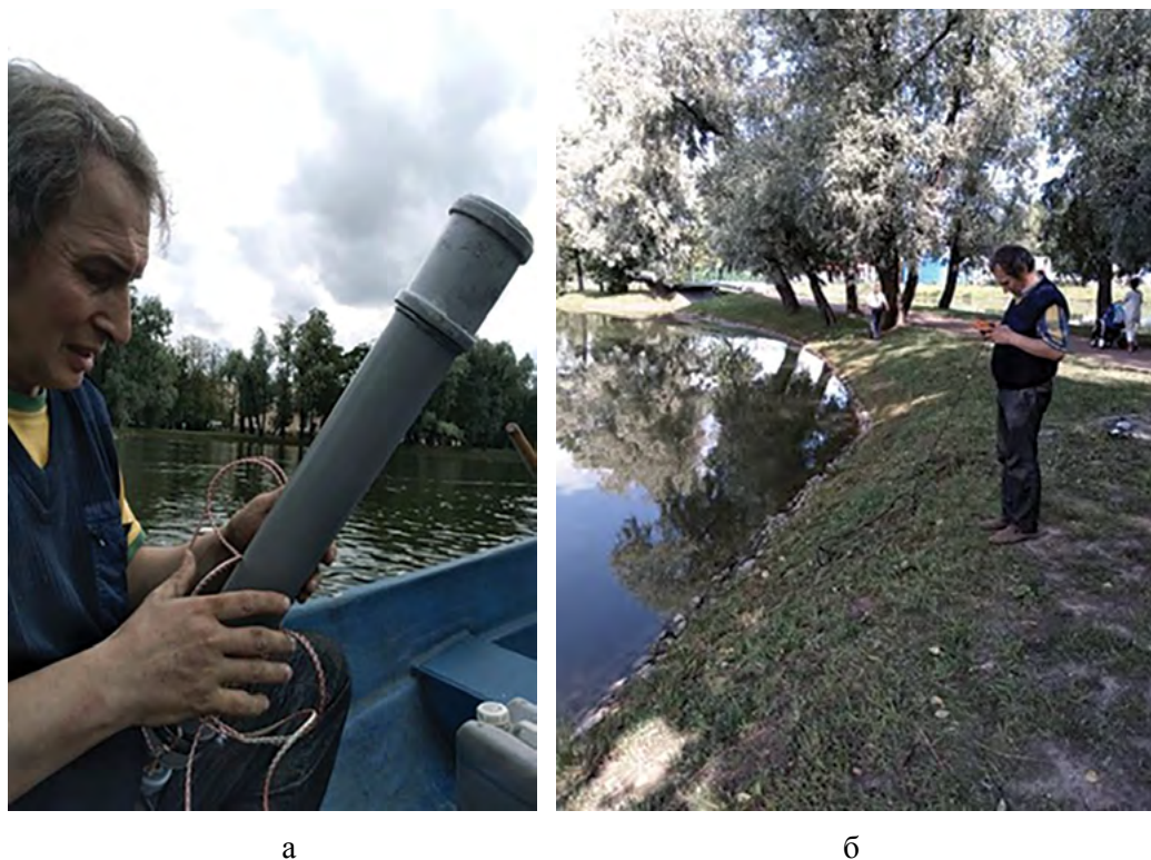
Рис. 10.9. Работы на Матросском пруду 2020 г.: осмотр контейнера с ультразвуковым излучателем перед его установкой (а), контроль уровня акустического сигнала в воде пруда (б)
