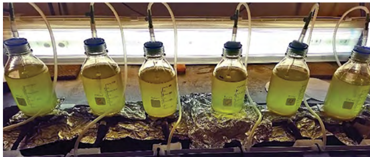
Рис. 10.1. Плечо с пятью каналами с излучателями и контрольным каналом лабораторной ультразвуковой установки для моделирования
