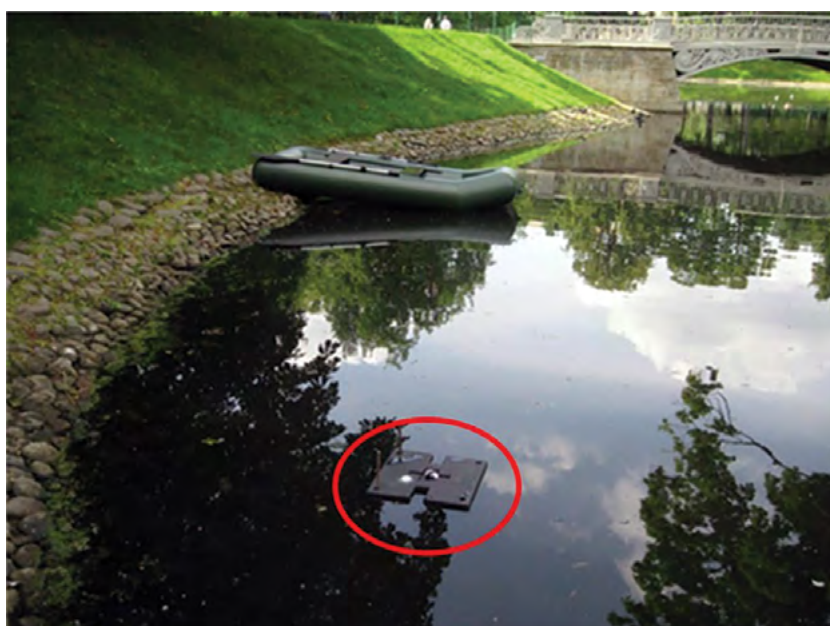
Рис. 10.4. Ультразвуковая установка SS-400, поставленная у берега с помощью плотика в контрольной части пруда Михайловского сада
