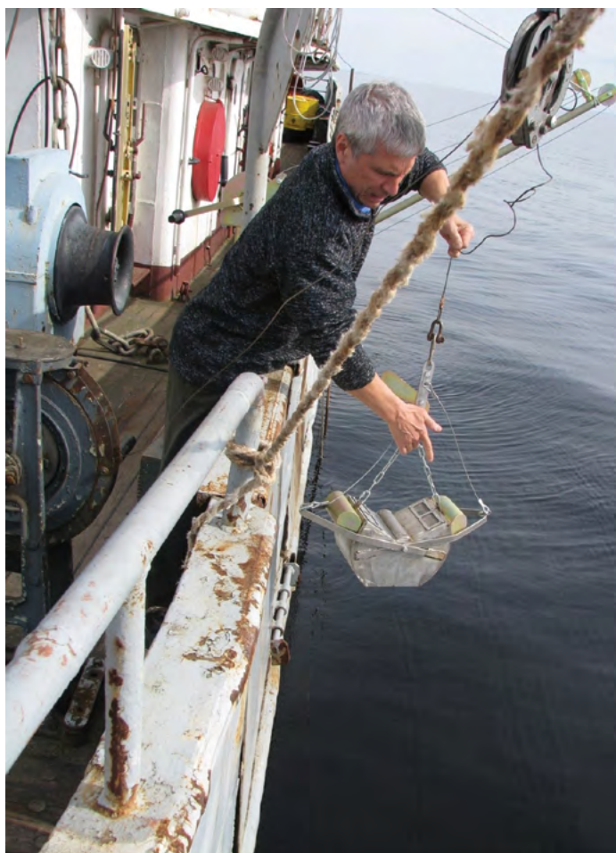
Рис. 11.8. Поздняков Ш.Р. работает с утяжеленным дночерпателем Петерсона
