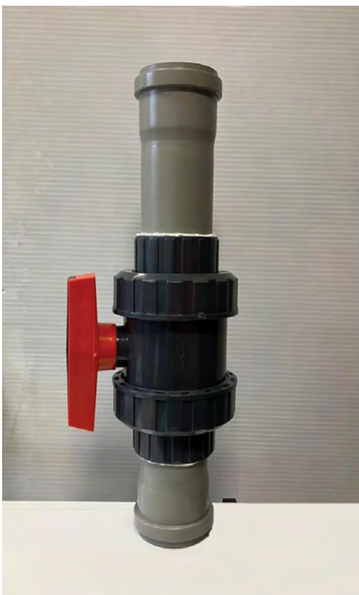
Рис. 11.2. Установка с шаровым краном для экстракции микропластика из донных отложений путем плотностного отделения
