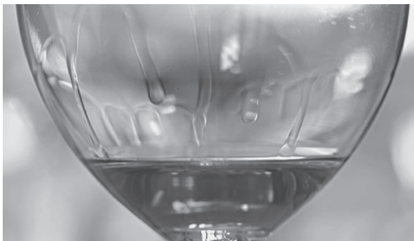
Рис. 1. Пограничный слой Марангони на стенках.
