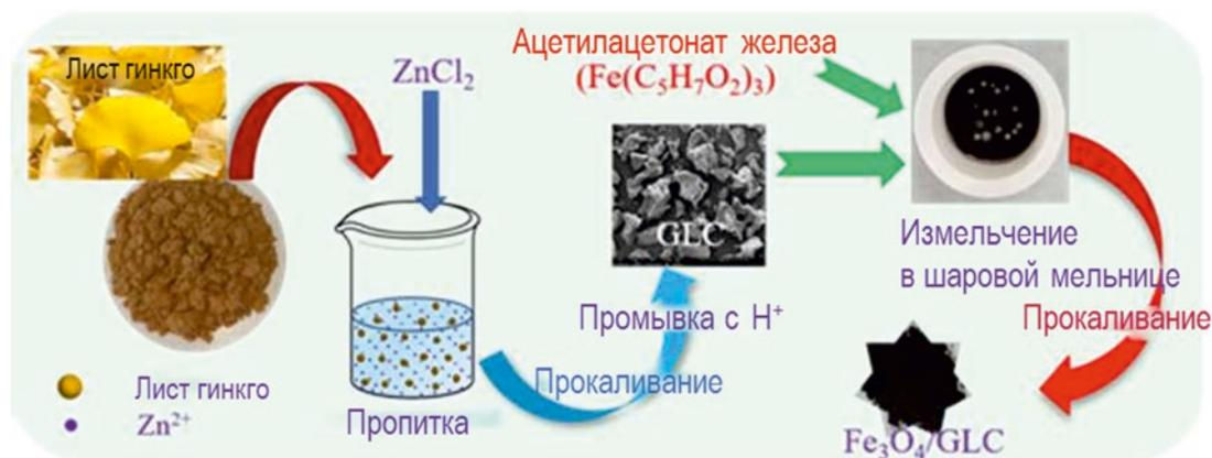
Рис. 1. Схема синтеза катализатора  $Fe_3O_4/GLC$ .
