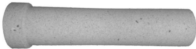
**Рис. 1.** Пористый керамический конвертер трубчатой конфигурации.
