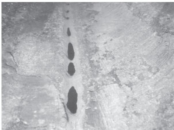
Рис. 1. Щелевая коррозия в технологических трубопроводах.
