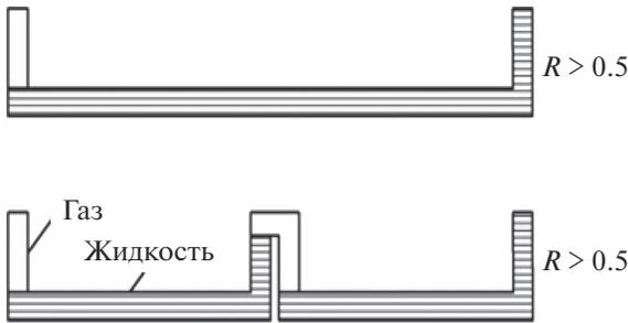
Рис. 2. Профили трассы трубопроводов при различных коэффициентах рельефа ( $R_k = h_{\text{вос}}/L$ ).
