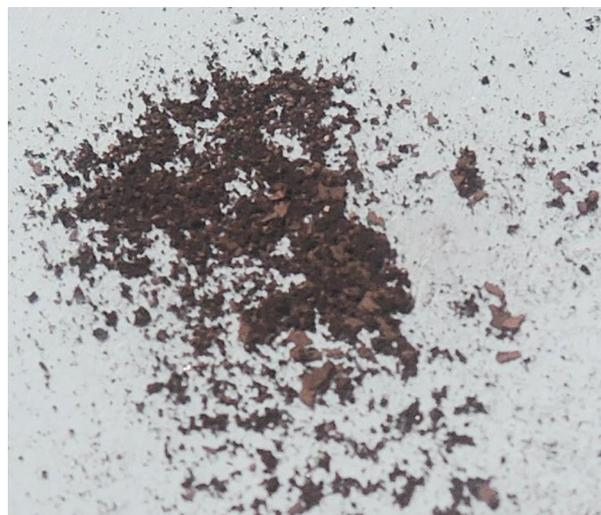
**Рис. 3.** Осадок меди. Раствор: 0.1 М  $\text{CuSO}_4$  и 1 М  $\text{CH}_3\text{OH}$ . Поглощенная доза 63 кГр.
