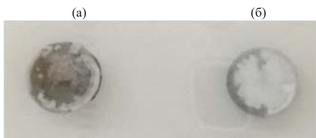
Рис. 1. Нанесение \text{Ba}(\text{NO}_3)_2 на металлические подложки: (а) из водного раствора, (б) из суспензии в 80%-ном этаноле.
