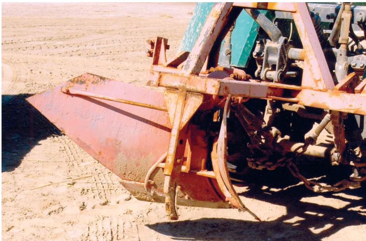
**Рис. 2.** Орудие для нарезки песконакопительных борозд со щелевателем.
