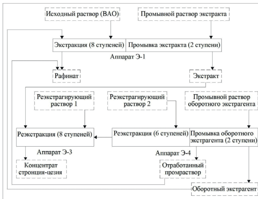
Рис. 5. Принципиальная аппаратурно-технологическая схема извлечения Cs и Sr на установке УЭ-35 в 1999 г.
