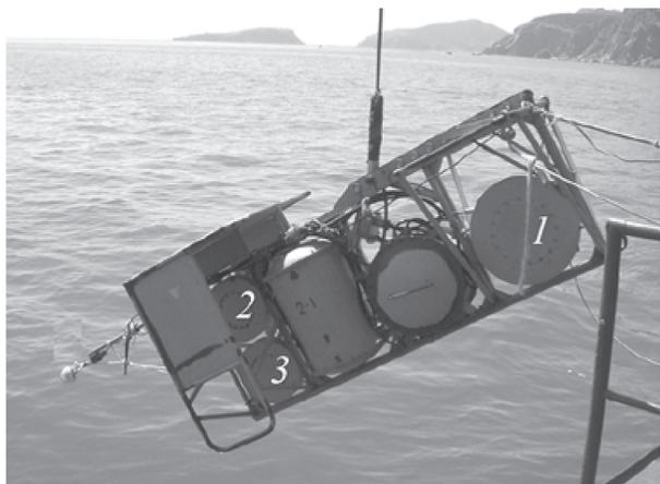
**Рис. 3.** Излучающий комплекс перед спуском на воду. В центре расположены бак противодавления и компьютер с часами. Излучатели 1, 2 и 3 соответствуют частотам 117, 320 и 680 Гц. Пинг-понг закреплён вблизи штанги.
