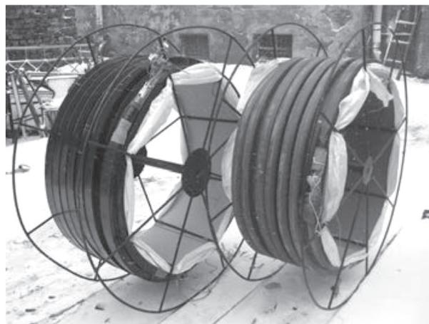
**Рис. 2.** Цельнозалитые скалярные антенны. Слева – эквидистантная антенна, справа – не эквидистантная. Обе антенны являются эластичными, многоканальными и имеют длину по 50 м.
