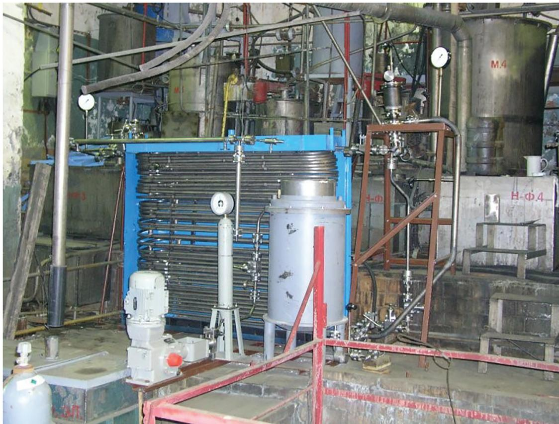
Фиг. 25. Опытно-промышленная трубная установка высокотемпературного выщелачивания ценных компонентов (BTV-50), внедренная на Медном заводе ОАО "НОРИЛЬСКНИКЕЛЬ" (Создание..., 2006).
