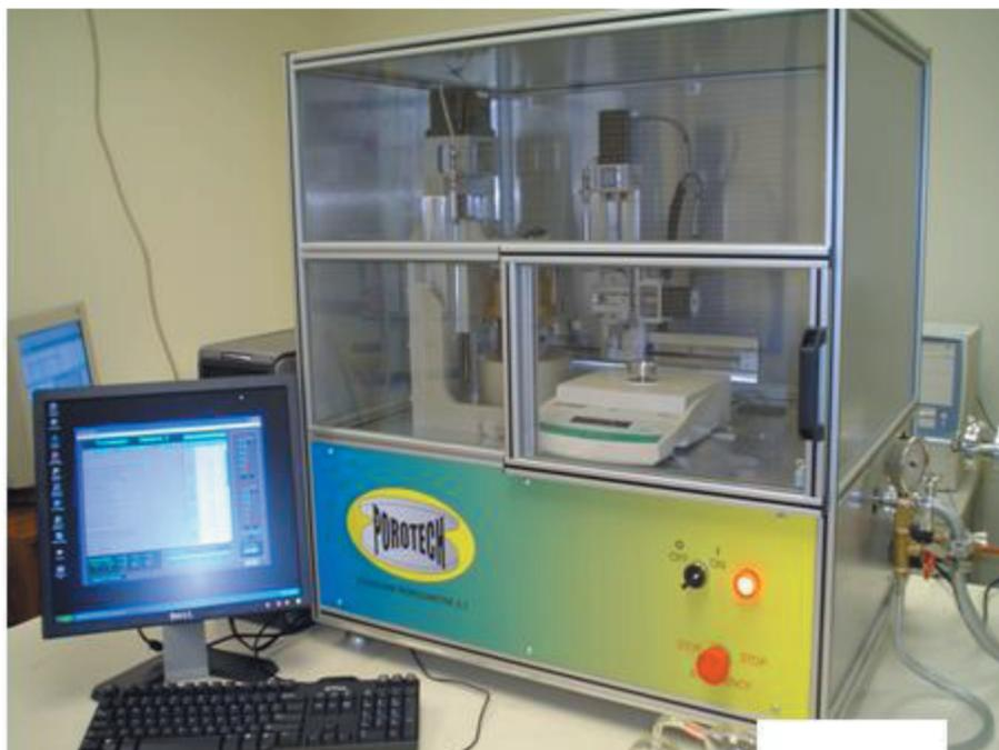
Рис. 1. Автоматический эталонный поромер роботизированного типа [26].
