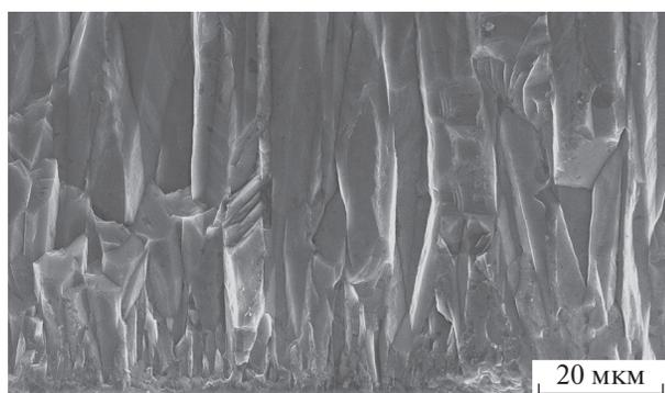
**Рис. 2.** Изображение поликристаллической алмазной пленки в поперечном сечении, полученное в растровом электронном микроскопе.
