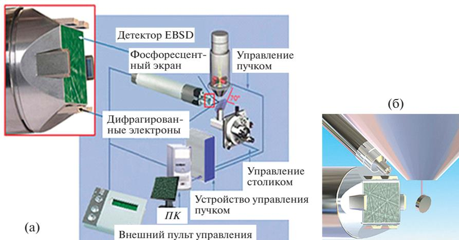
Рис. 4. Схема получения картин ДОЭ (а) и их увеличенное изображение в камере (б). По данным [28].
