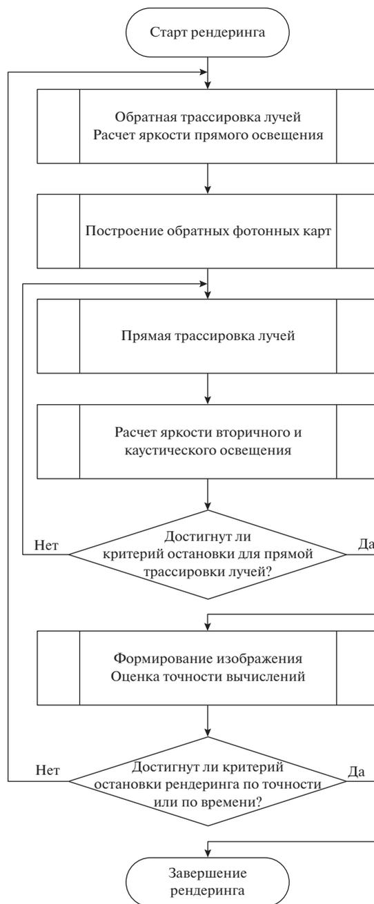
Рис. 6. Блок-схема алгоритма рендеринга методом прогрессивных обратных фотонных карт.
