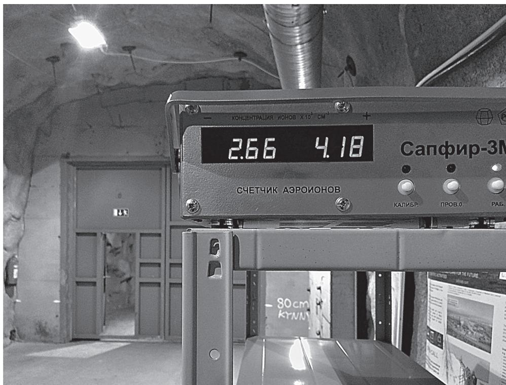
**Рис. 3.** Фото серийного счетчика ионов Сапфир-3М, расположенного в подземной лаборатории Центра подземной физики частиц (CUPP) университета Оулу (Финляндия) в медной шахте Пюхясалми (Puhäsalmi) на глубине 1440 м. На дисплее счетчика видны значения измеренных концентраций: отрицательно заряженных аэроионов –  $2.66 \times 10^3 \text{ см}^{-3}$  и положительно заряженных аэроионов –  $4.18 \times 10^3 \text{ см}^{-3}$ .
