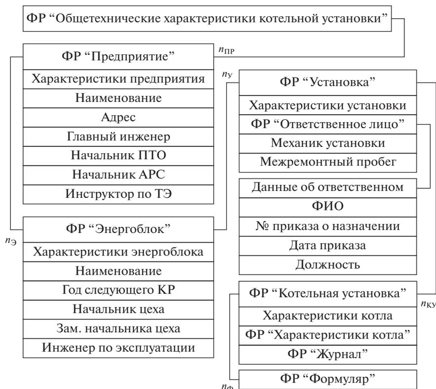
**Рис. 6.** Фрейм-прототип "Общетехнические характеристики КУ".  $n_{ПР}$  – количество предприятий в компании;  $n_{Э}$  – количество энергоблоков на предприятии;  $n_{У}$  – количество технологических установок в энергоблоке;  $n_{КУ}$  – количество котельных установок в технологической установке;  $n_{Ф}$  – количество формуляров КУ; ПТО – планово-технический отдел; АРС – аварийно-ремонтная служба; ТЭ – техническая эксплуатация; КР – капитальный ремонт.
