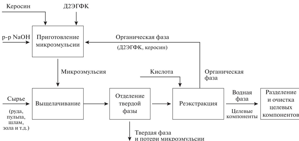
Рис. 4. Обобщенная схема микроэмульсионного выщелачивания [74, 79].
