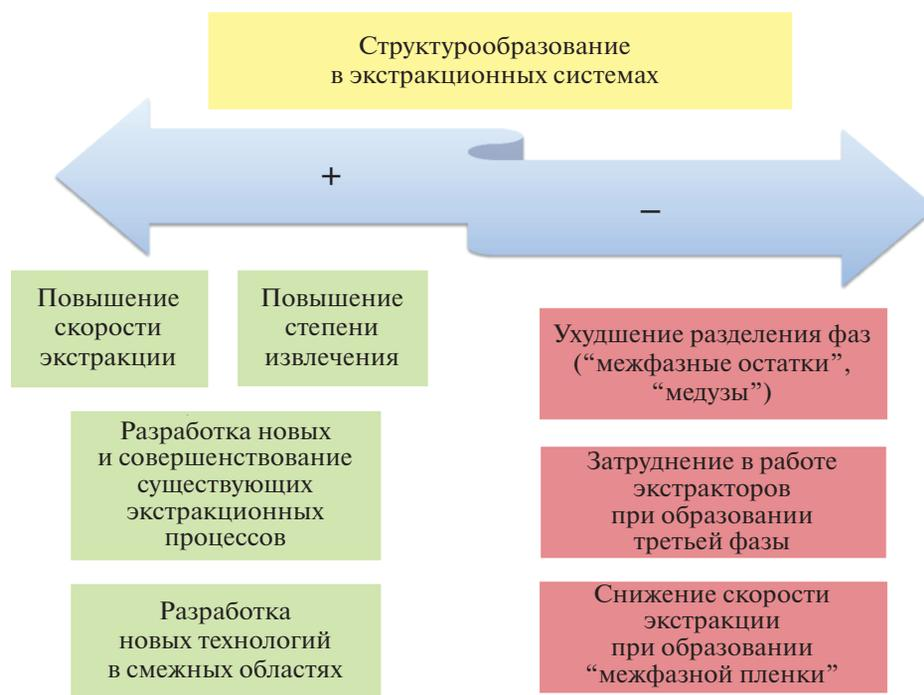
Рис. 5. Проблемы и перспективы структурообразования в экстракционных системах.
