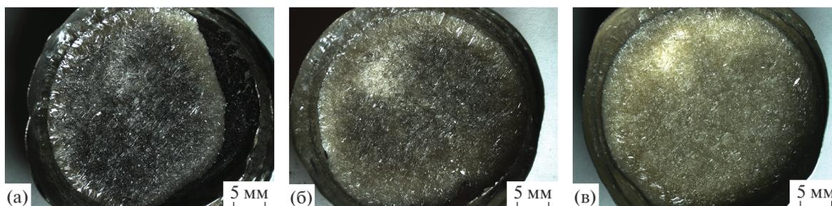
Рис. 6. Макроструктура образцов, полученных охлаждением расплава в тигле на воздухе из разных температурных зон: а – зона *C*, б – *B*, в – *A*.
