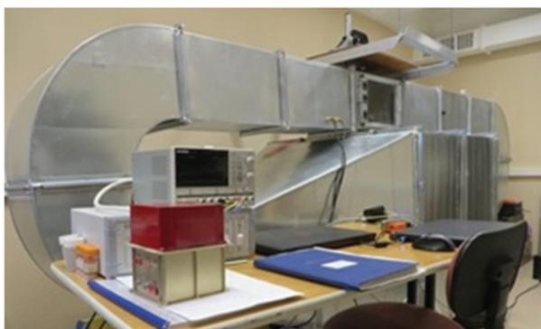
**Рис. 15.** Внешний вид аэродинамической трубы.
