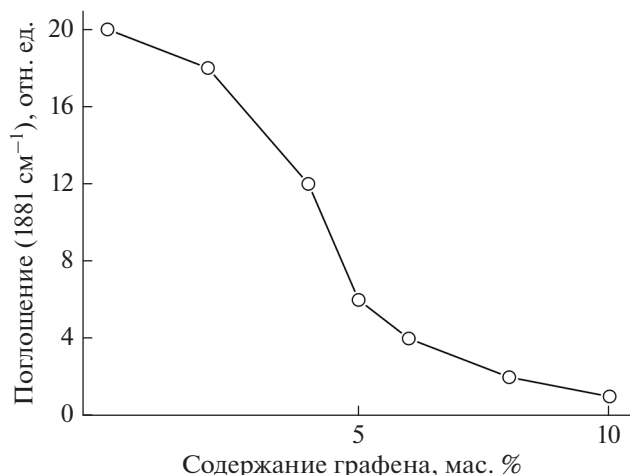
Рис. 4. Зависимость относительной интенсивности пика поглощения с максимумом 1881 к пику 1206 см -1 от концентрации МГНП в полимерном композите ПТФЭ/МГНП.
