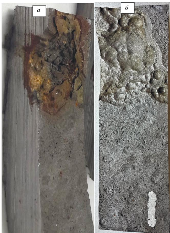
Рис. 5. Внешний вид вырезанного сегмента № 1 на патрубке 1 с коррозионной аномалией: *а* — после первого травления; *б* — после второго травления и полного удаления продуктов.
