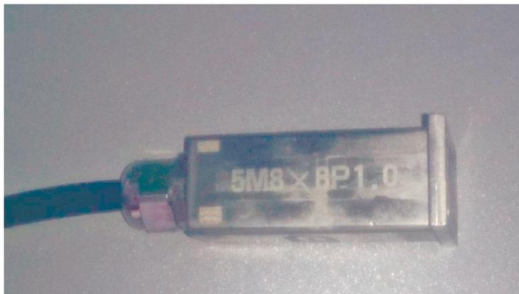
Рис. 4. Ультразвуковой преобразователь Doppler 5M8×8P1.0.
