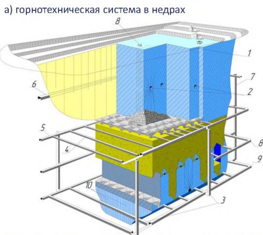
Обозначения к рис. а: 1 – рудная залежь; 2 – буровой орт; 3, 7 – рудоспуски; 4 – откаточный орт; 5, 6, 9 – откаточный и вентиляционные штреки; 8 – буровое оборудование открытых горных работ; 10 – камеры подземного рудника; 11 – камера-реактор для выщелачивания руд.
