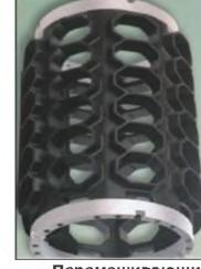
Перемешивающие устройства химического реактора
