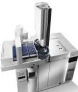
Хромато-масс-спектрометрическая система 7890 A/5975C для определения органической составляющей в ВМ
