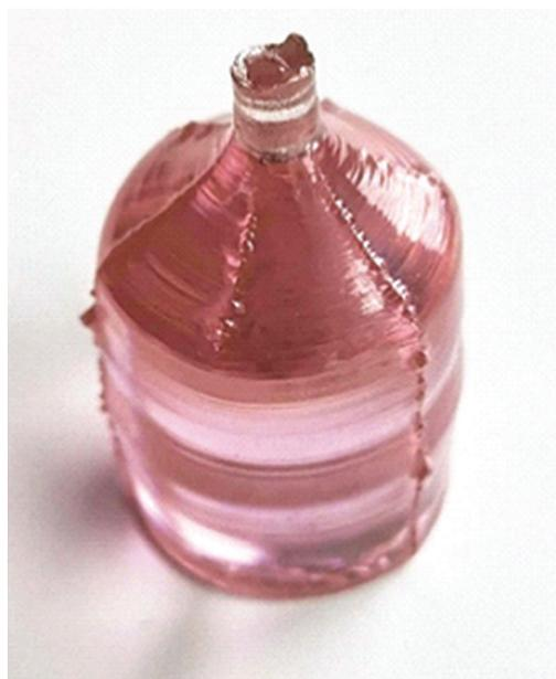
**Рис. 2.** Внешний вид кристалла  $\text{LiNbO}_3:\text{Zn}$  (2.48 мас. %) :Er (0.98 мас. %).
