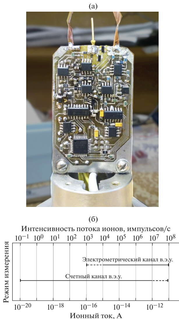
Рис. 3. Внешний вид установленной в головке в.э.у. платы счетно-электрометрической системы регистрации (а); б – диапазоны измерения счетного и электрометрического каналов.
