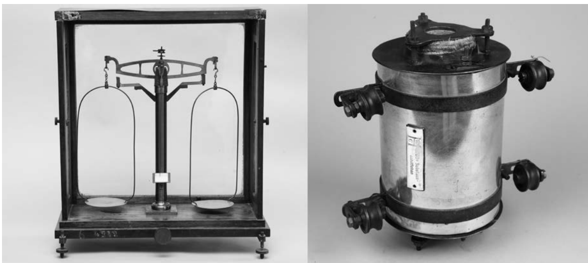
Рис. 6. Оборудование из лаборатории Н.Д. Зелинского в Московском университете. Слева – весы аналитические коромысловые равноплечие. Москва, 1870-е гг. Изготовлены в Мастерской магистра химии А. Гедвилло. Справа – печь лабораторная для сжигания, с электрообогревом. Германия. 1900–1920 гг. Предметы из Личного фонда Н.Д. Зелинского (фонд № 204), собрание Политехнического музея
