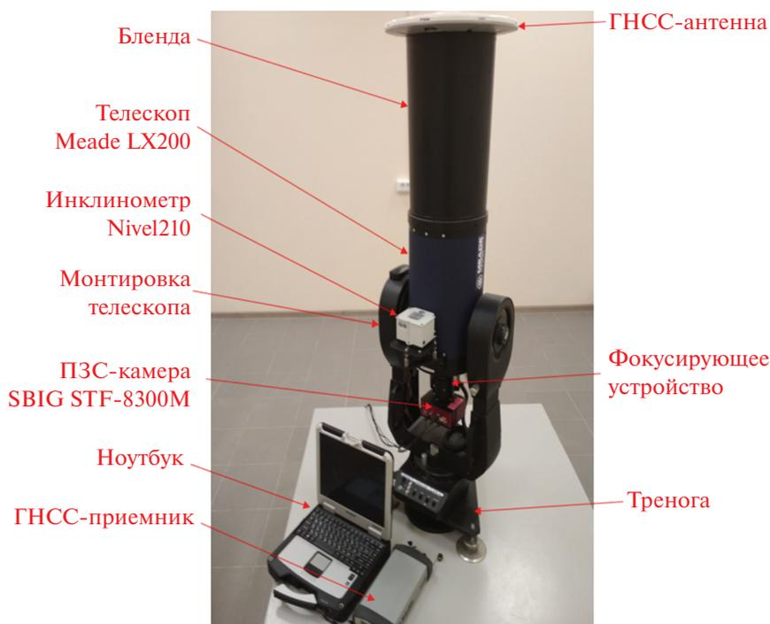
Рис. 4. Макет астроизмерителя УОЛ.
