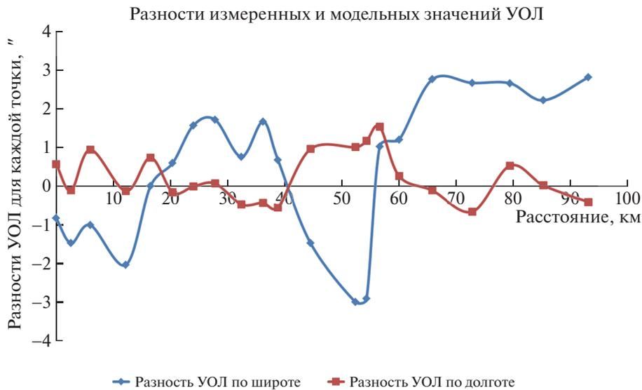
Рис. 7. Разности УОЛ между измеренным и модельным профилями.
