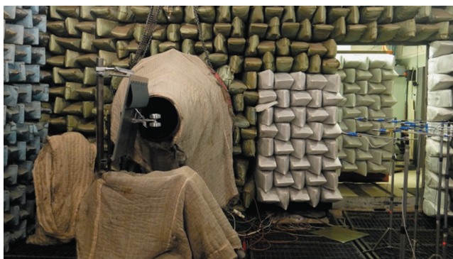
Рис. 1. Фотография заглушенной камеры АК-2 ЦАГИ.
