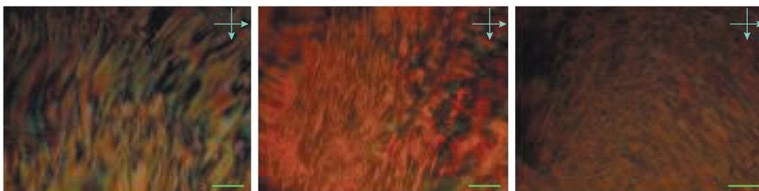
**Рис. 7.** Холестерические текстуры дисперсии ГО при концентрации (слева направо) 0.38, 0.60 и 0.76 об. %, наблюдаемые в поляризационном микроскопе. Масштабная метка – 200 мкм [30].
